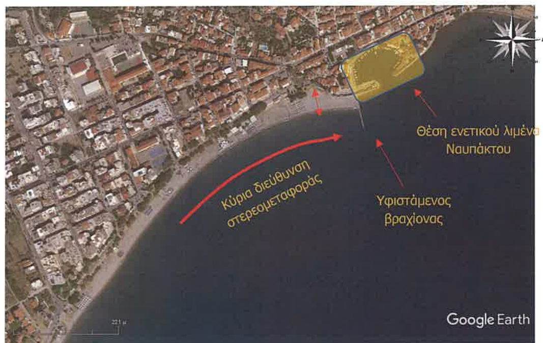
Σχήμα 11: Τάση στερεομεταφοράς στην ακτή ενδιαφέροντος – πρόσχωση δυτικώς υφιστάμενου βραχίονα.
